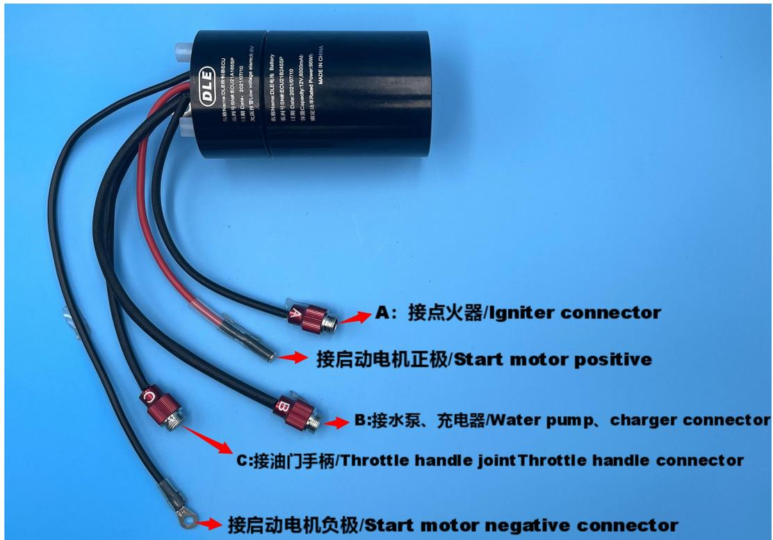
3、注意检查与控制器相连接的接头是否接好，检查接头处红色密封圈（如图所示）是否有损坏或脱落，请及时更换。
