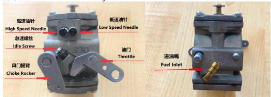
**调整:** 顺时针转动怠速螺丝3将增大怠速转速,同时要配合低速油针4一起调整,顺时针转动低速油针减少油量(一般是把油针拧到底再退回1.5圈); 高速油针5(退回1.25圈)最好使用转速表来调整,使发动机达到最高转速,加减速顺畅为最佳。
